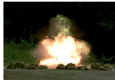
爆破施設における手製爆発物の爆破実験
